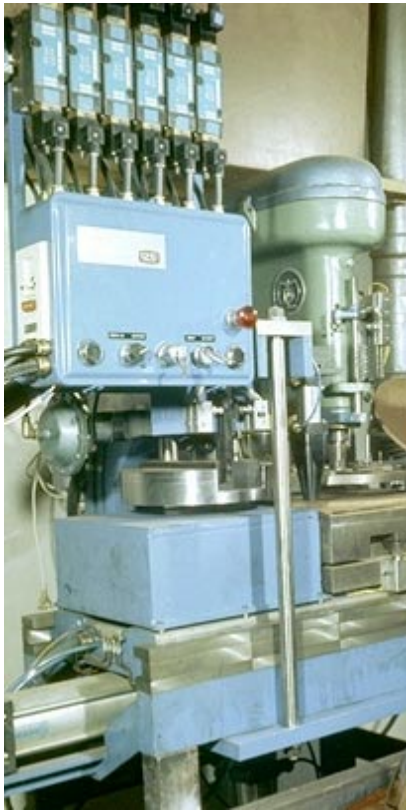
Abb. 2: Automatisierung mit Druckluft
