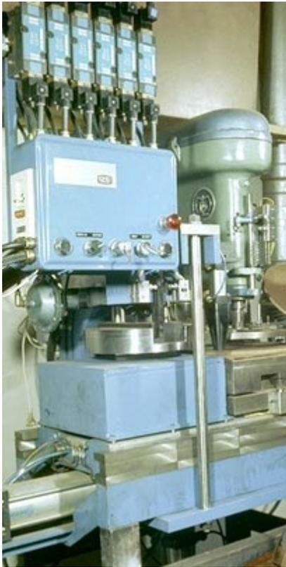
Abb. 2: Automatisierung mit Druckluft
